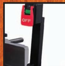
Кнопочный пост быстрого доступа
