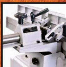
Параллельный упор с реечной передачей
