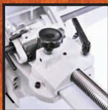
Параллельный упор с реечной передачей
