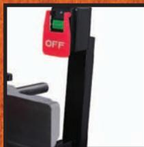
Кнопочный пост быстрого доступа
