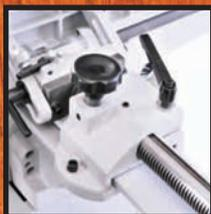
Параллельный упор с реечной передачей
