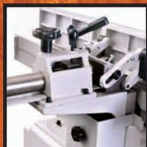
Параллельный упор с реечной передачей
