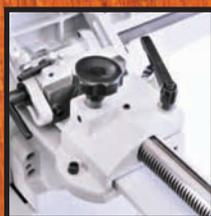
Параллельный упор с реечной передачей
