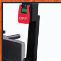
Кнопочный пост быстрого доступа
