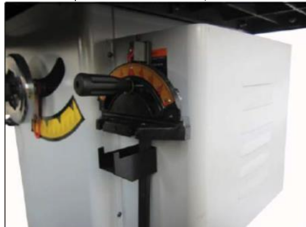
Рис. 14. Крепление кронштейна подручника
