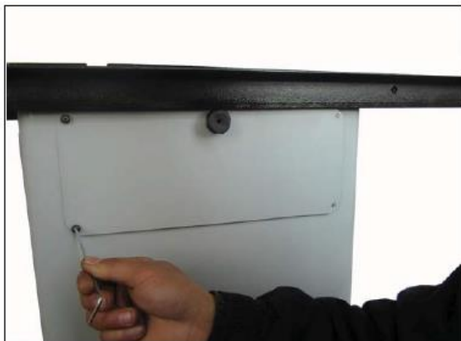
Рис. 33. Снять панель доступа к качающейся опоре
