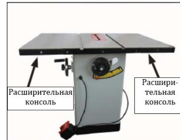
Рис. 6. Установленные на станке расширительные консоли
