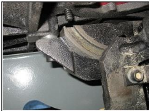
Рис. 24. Направляющие качающихся опор и червяк наклона
