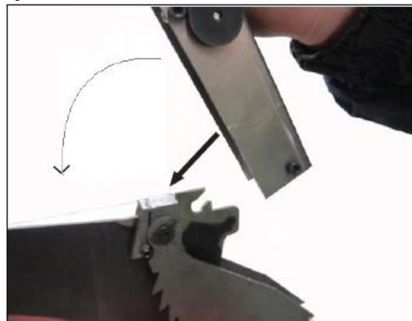
Рис. 20. Ограждение дисковой пилы
