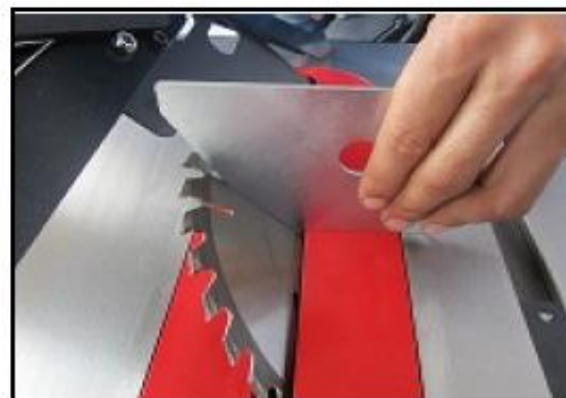
Рис. 29. Наклон дисковой пилы на угол 45^\circ
