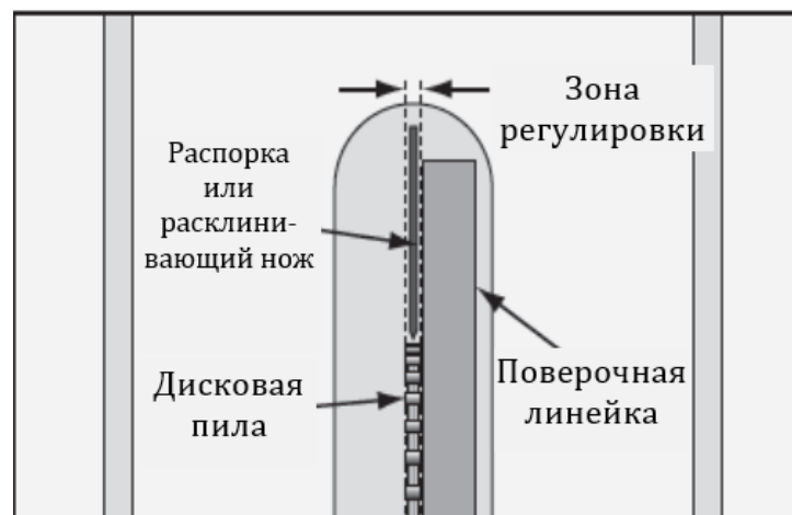
Рис. 36. Зона регулировки распорки или расклинивающего ножа
