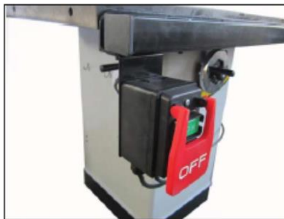
Рис. 12. Закреплённый на направляющей выключатель
