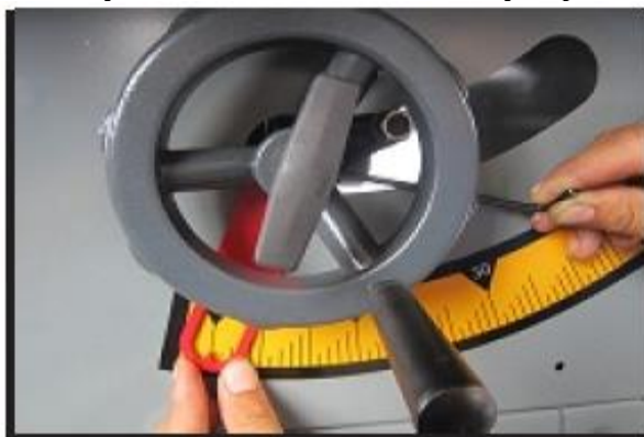
Рис. 28. Установка указателя на 0^\circ
