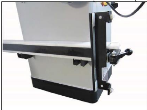
Рис. 15. Крепление двух кронштейнов подручника
