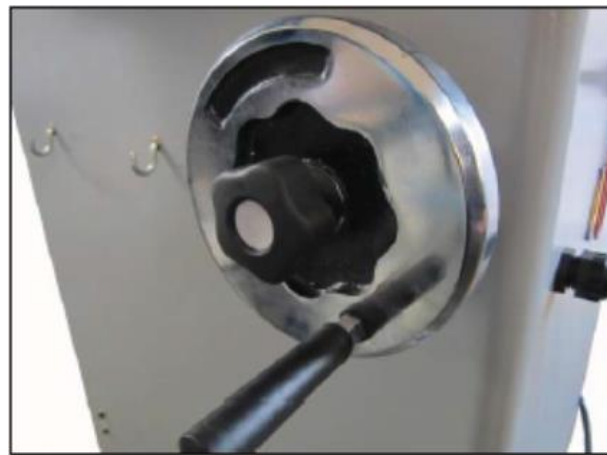
Рис. 5. Рукоятка маховичка и фиксирующая рукоятка
