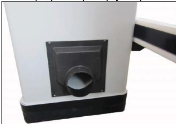
Рис. 17. Крепление штуцера аспирации опилок
