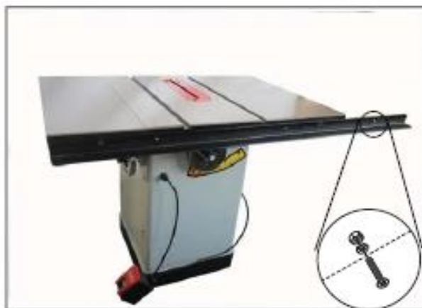
Рис. 9. Установленная на станке передняя направляющая
