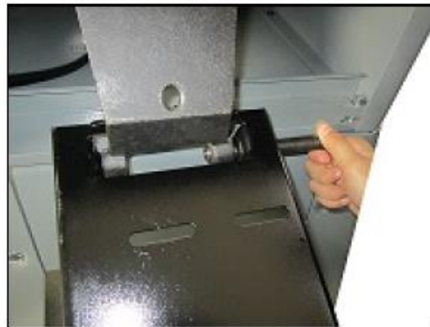
Рис. 21. Регулировка натяжения ремня
