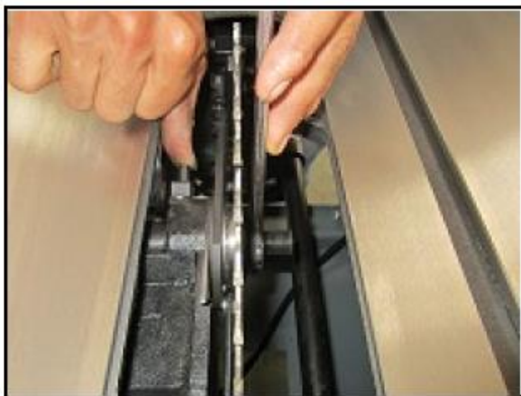
Рис. 26. Крепление дисковой пилы
