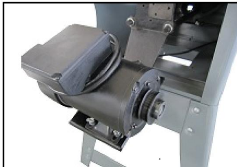
Рис. 23. Двигатель, закреплённый на монтажной плите
