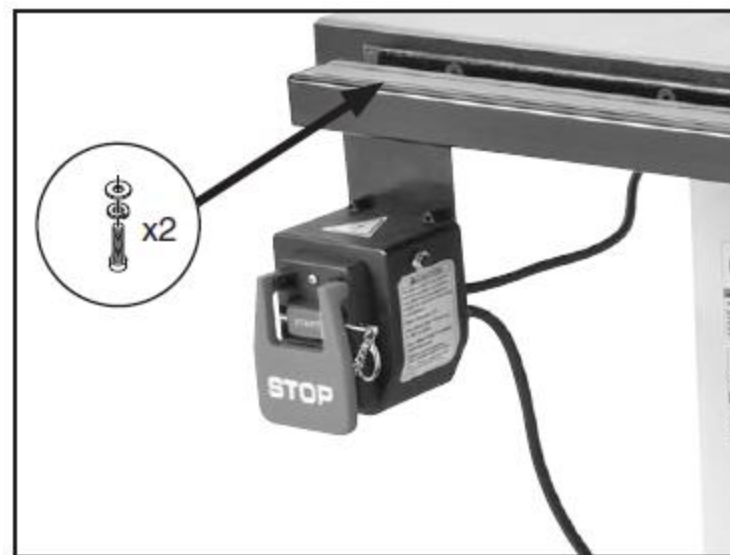
Рис. 21. Установленный магнитный пускатель
