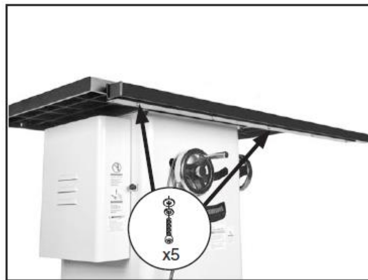
Рис. 16. Прямоугольная труба, закреплённая на передней направляющей
