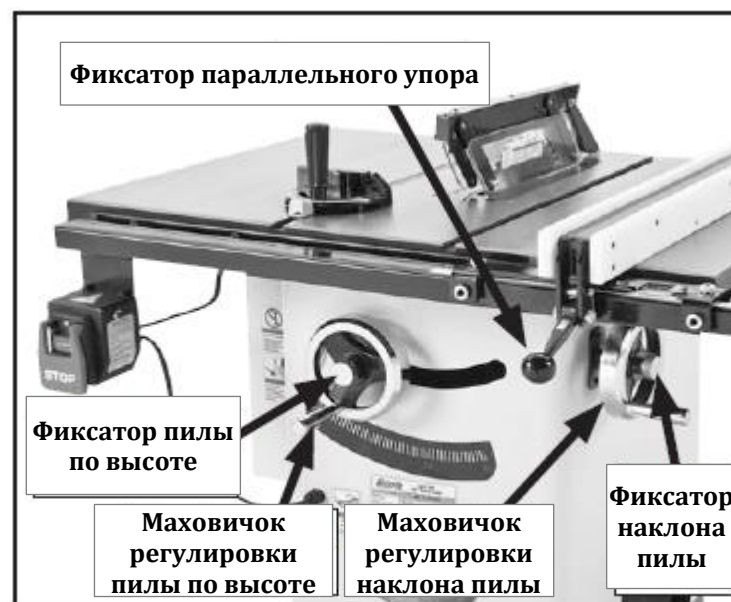
Рис. 24. Органы управления циркулярной пилой
