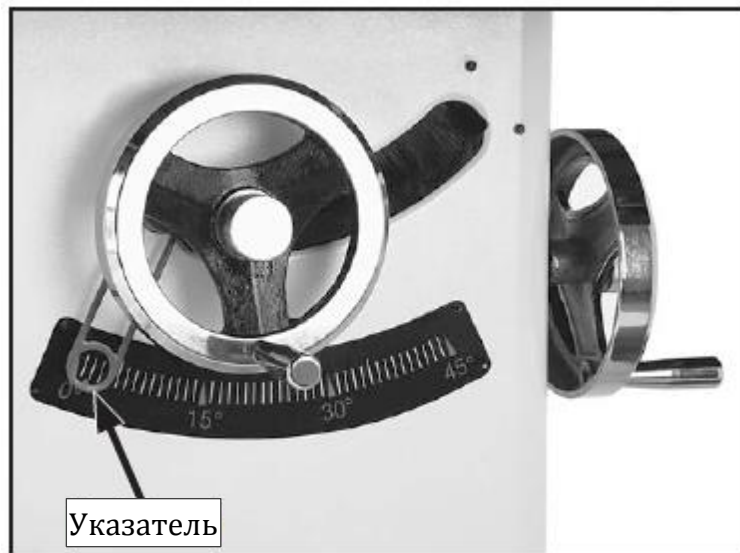
Рис. 63. Стрелка указателя наклона
