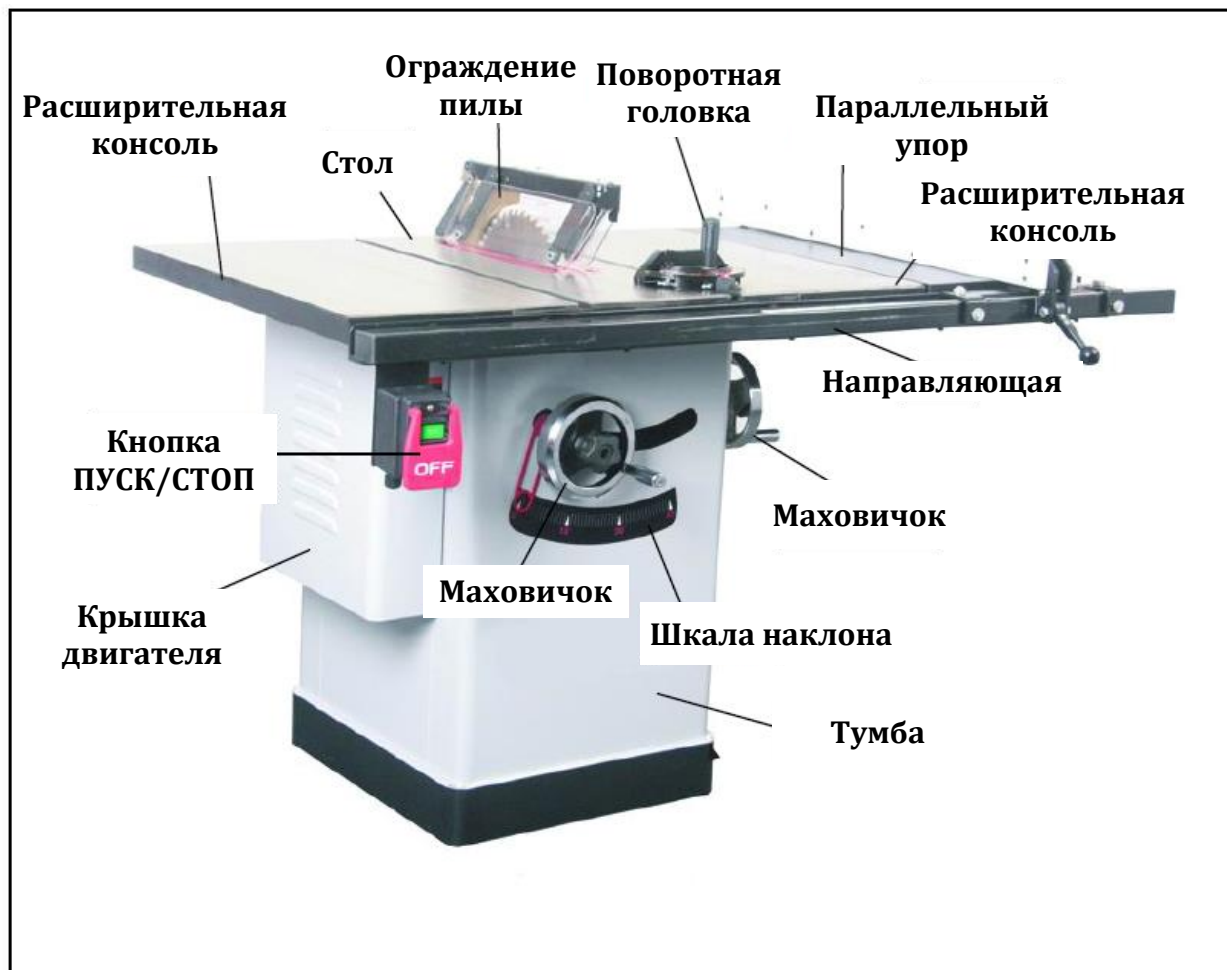
Рис. 1. Основные органы управления и элементы станка
