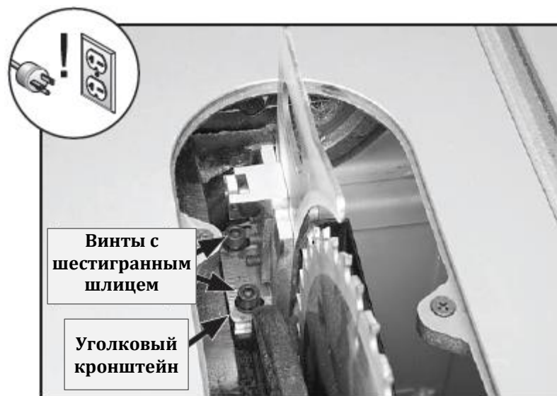
Рис. 76. Винты с шестигранным шлицем для регулировки положения распорки или расклинивающего ножа
