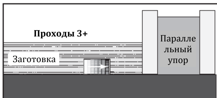
Рис. 50. Дополнительные резы однодисковой пилой
