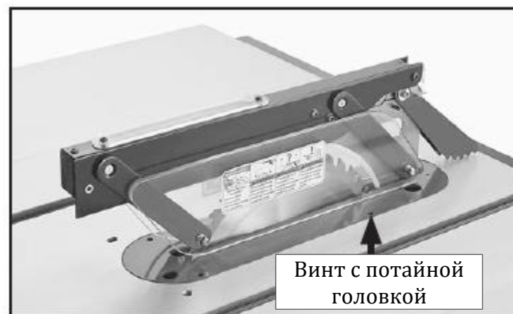
Рис. 36. Установленное ограждение пилы
