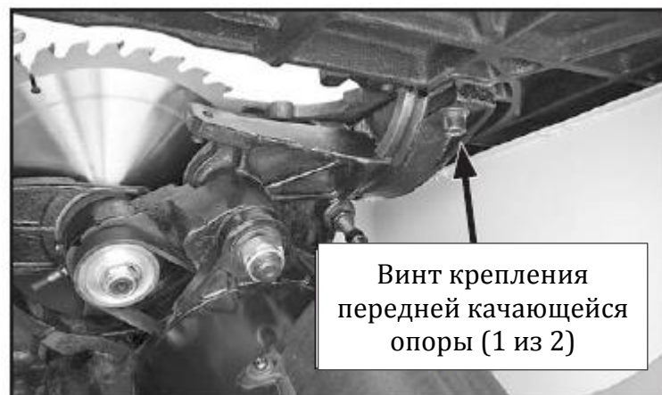
Рис. 71. Винт крепления передней качающейся опоры
