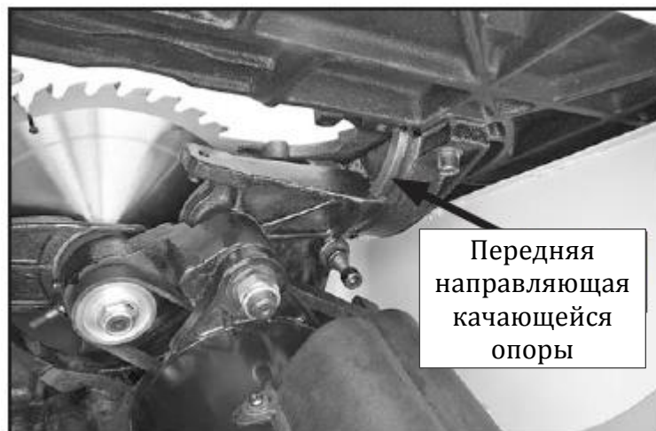
Рис. 59. Направляющая качающейся опоры (показана только передняя направляющая)
