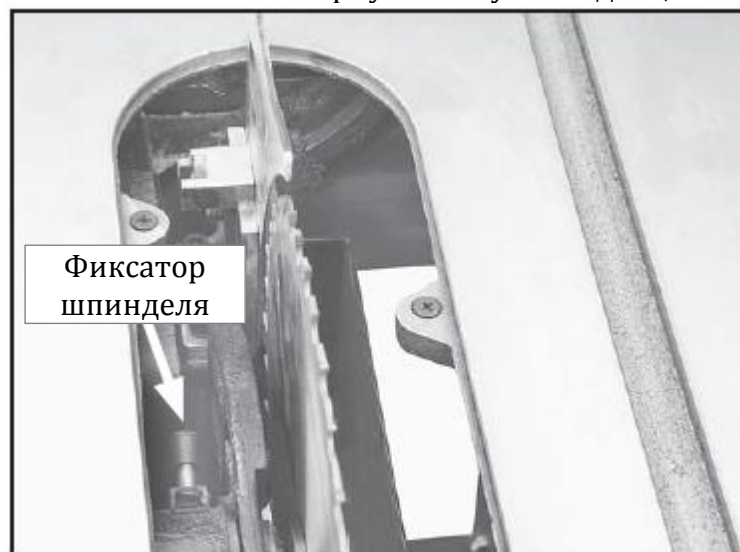
Рис. 32. Расположение фиксатора шпинделя
