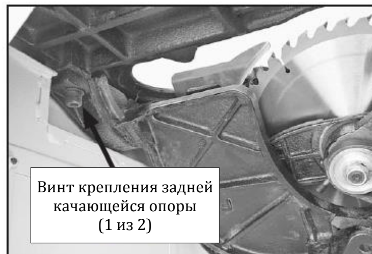
Рис. 70. Винт крепления задней качающейся опоры
