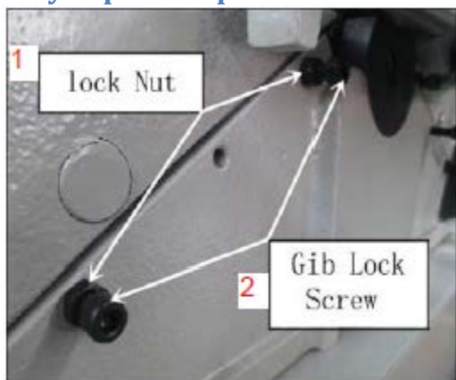
Рис. 20: 1 – контргайка, 2 – винт фиксации прижимной планки направляющей
