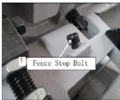
Рис. 19: 1 – упорный болт параллельного упора
