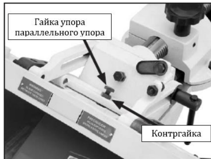
Рис. 25. Контргайка упора под 45°
