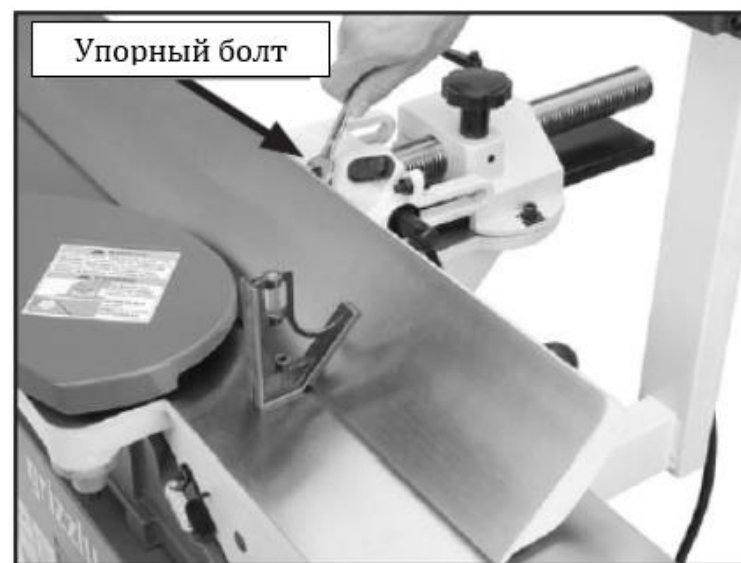
Рис. 29. Контргайка упора под углом 45^\circ положения параллельного упора
