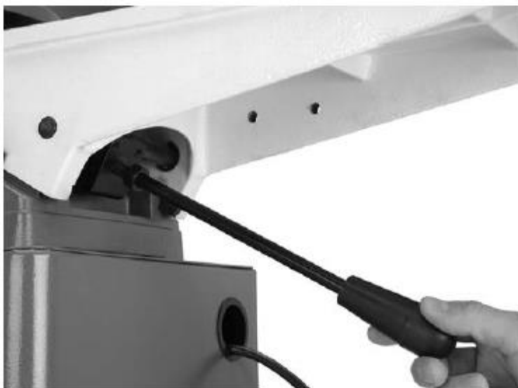
Рис. 16. Установка рычага подводного стола
