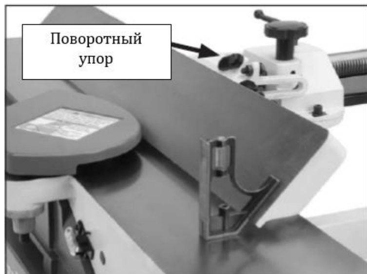
Рис. 28. Регулировка параллельного упора под углом 45^\circ наружу
