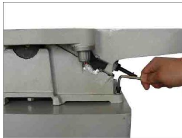
Рис. 4. Установка переднего крепёжного болта
