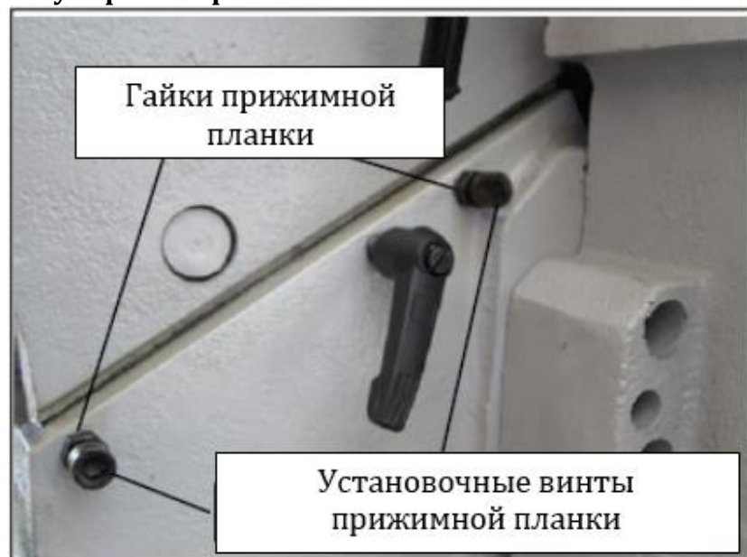
Рис. 30. Органы регулировки прижимных планок выводного стола
