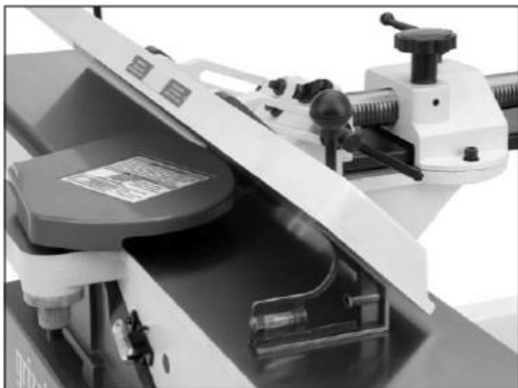
Рис. 24. Настройка под угол 45° внутрь
