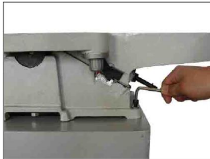
Рис. 4. Установка переднего крепёжного болта
