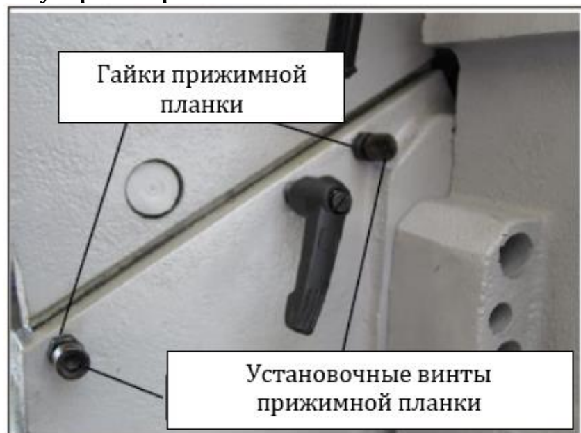
Рис. 30. Органы регулировки прижимных планок выводного стола
