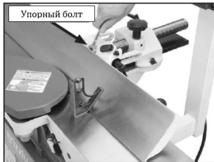
Рис. 29. Контргайка упора под углом 45° положения параллельного упора
