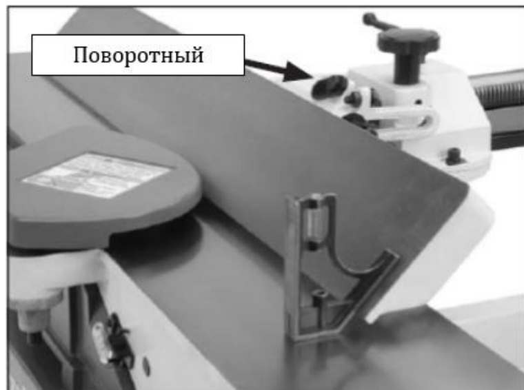
Рис. 28. Регулировка параллельного упора под углом 45° наружу
