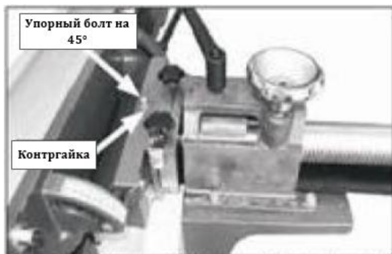
Рис. 50. Регулировка параллельного упора под 45° наружу
