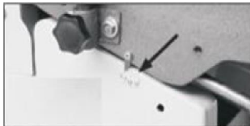
Рис. 45. Шкала глубины резания, установленная в нулевое положение
