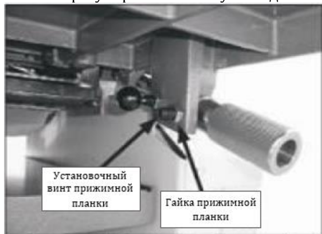
Рис. 52. Регулировка прижимной планки подводного стола
