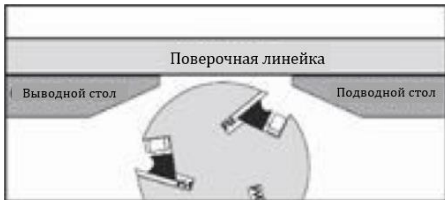
Рис. 34. Установленные вровень подводной и выводной столы
