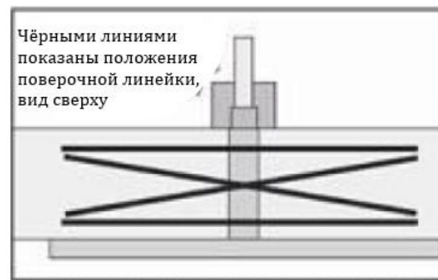
Рис. 35. Положения поперечной линейки при проверке параллельности подводного и выводного столов
