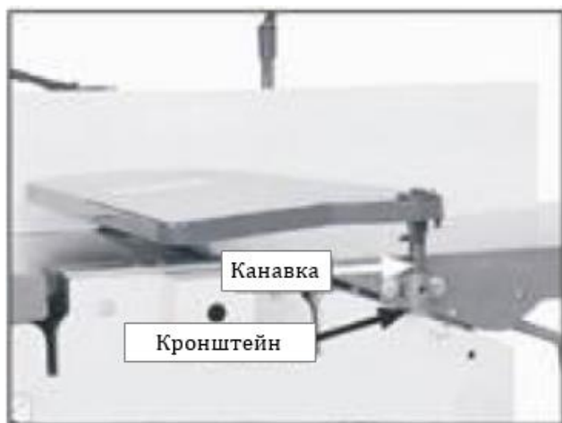
Рис. 10. Установка ограждения режущего вала
