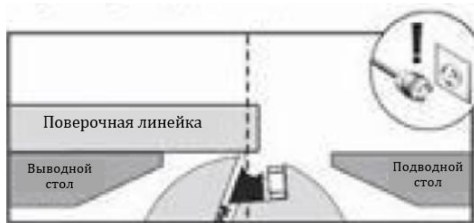
Рис. 9. Использование поверочной линейки для выравнивания выводного стола
