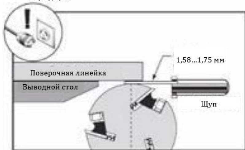
Рис. 32. Проверка щупом высоту выводного стола относительно режущего вала
