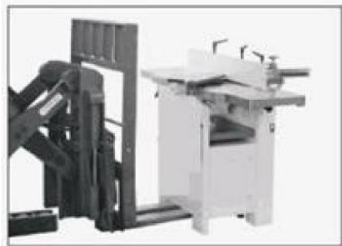
Рис. 5. Поднятие станка вилочным погрузчиком
