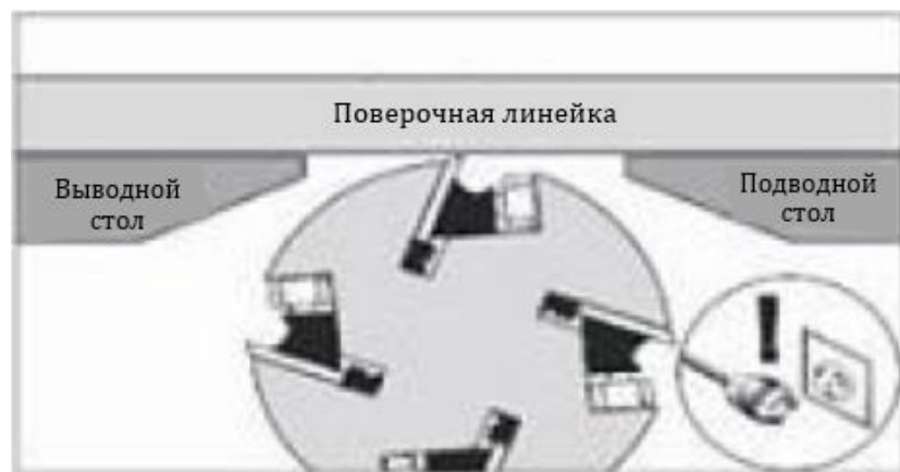
Рис. 44. Установленные вровень подводной и выводной столы
